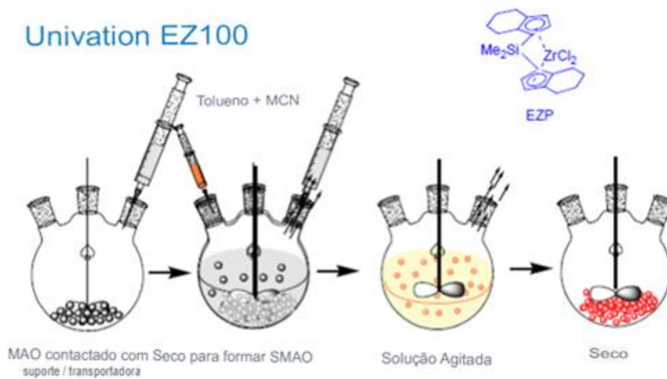
Figura 23: obtenção do catalisador Univation EZ100. Imagem adaptada de [3].
