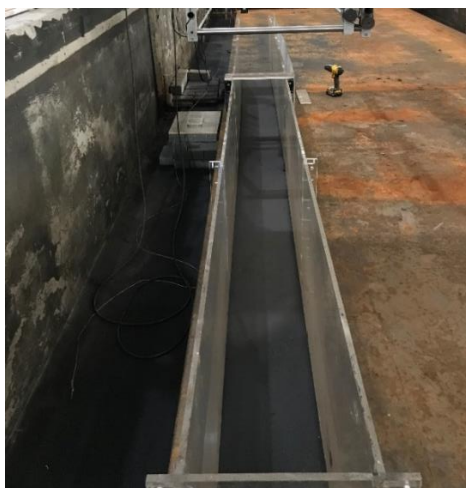
Figura 24 - Canal de acrílico de simulação das correntes de turbidez.
