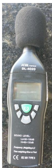
Figura 2 – Decibelímetro DL-4020, modelo da marca ICEL Manaus.
