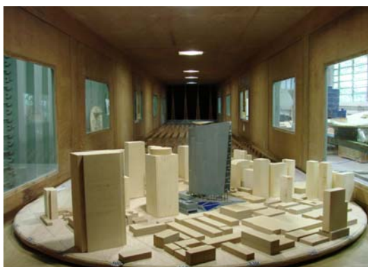
Figura 25: modelo reduzido no interior do túnel de vento Prof. Joaquim Blessmann, edifício Leopoldo Green (Loredou-Souza, 2008f)
