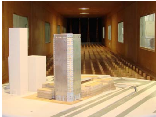
Figura 16: modelo reduzido no interior do túnel de vento Prof. Joaquim Blessmann, edifício Atlanta (Loredo-Souza, 2007c)
