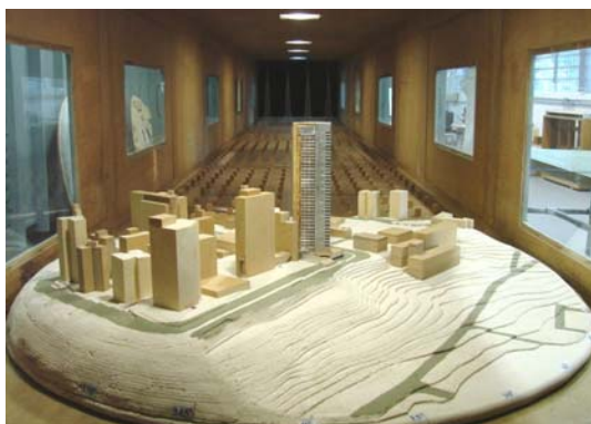
Figura 37: modelo reduzido no interior do túnel de vento Prof. Joaquim Blessmann, edifício Issa Hazbum (Loredou-Souza, 2008e)
