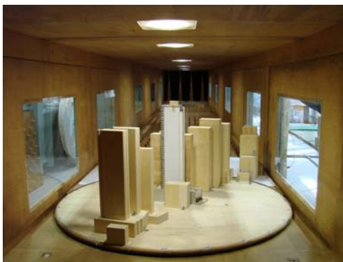
Figura 31: modelo reduzido no interior do túnel de vento Prof. Joaquim Blessmann, edifício Ocean Palace (Loredo-Souza, 2008c)
