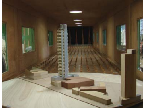
Figura 40: modelo reduzido no interior do túnel de vento Prof. Joaquim Blessmann, edifício Barra Tower (Loredo-Souza, 2007a)
