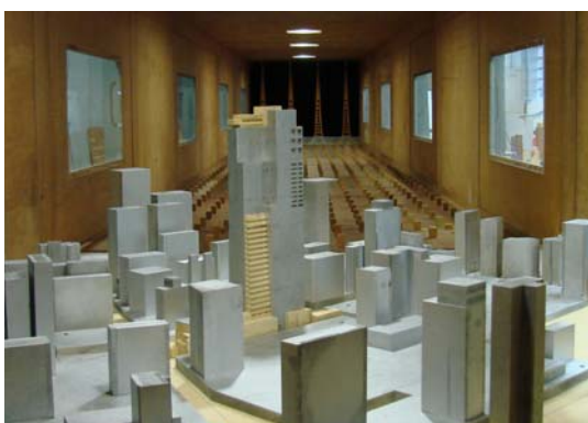
Figura 19: modelo reduzido no interior do túnel de vento Prof. Joaquim Blessmann, Torre Comendador Araújo (Loredo-Souza e Rocha, 2008b)
