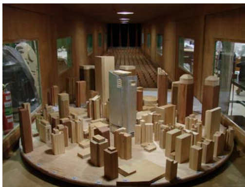
Figura 22: modelo reduzido no interior do túnel de vento Prof. Joaquim Blessmann, edifício Prosperitas (Loredou-Souza e Rocha, 2007b)
