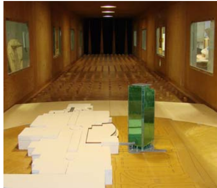
Figura 13: modelo reduzido no interior do túnel de vento Prof. Joaquim Blessmann, edifício Cristal Tower (Loredou-Souza, 2008g)
