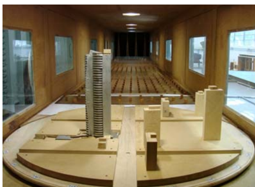
Figura 34: modelo reduzido no interior do túnel de vento Prof. Joaquim Blessmann, edifício Unique Residence (Loredo-Souza, 2008d)
