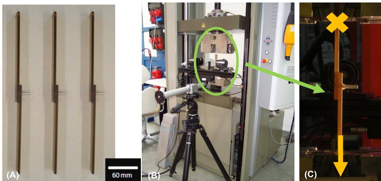
Figura 4.8 – Ensaio estático de cisalhamento em juntas sobrepostas monorrebitadas: A) Corpos de prova, B) Máquina de ensaio Zwick-Roell C) Representação esquemática da configuração (DS).
