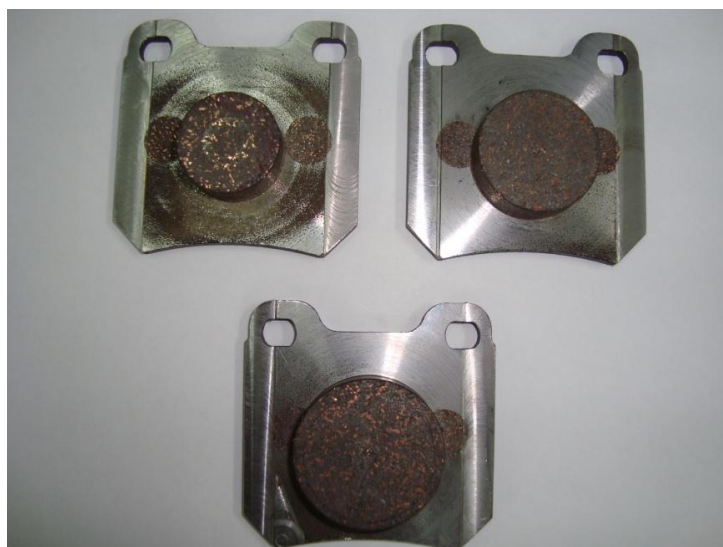
Figura 4.2 – Configurações dos corpos de prova utilizados no tribômetro.
