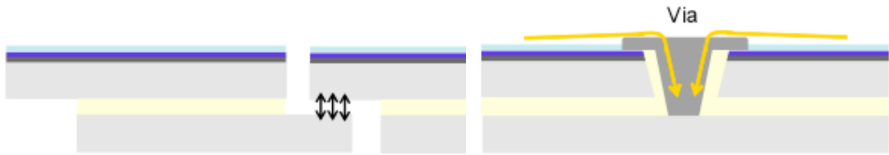
Figura 9: Interconexão de células Nanosolar e arquitetura de vias condutoras de corrente da superfície para a base metálica de alumínio. Fonte: Nanosolar
