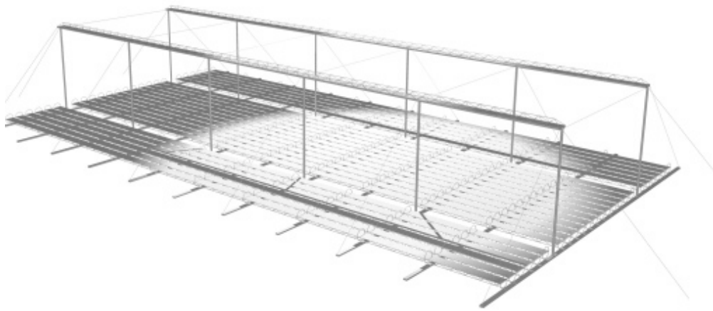
Figura 17: Sistema de concentradores planos de Fresnel sobre dois canais de absorção lineares. Fonte: University of Sydney
