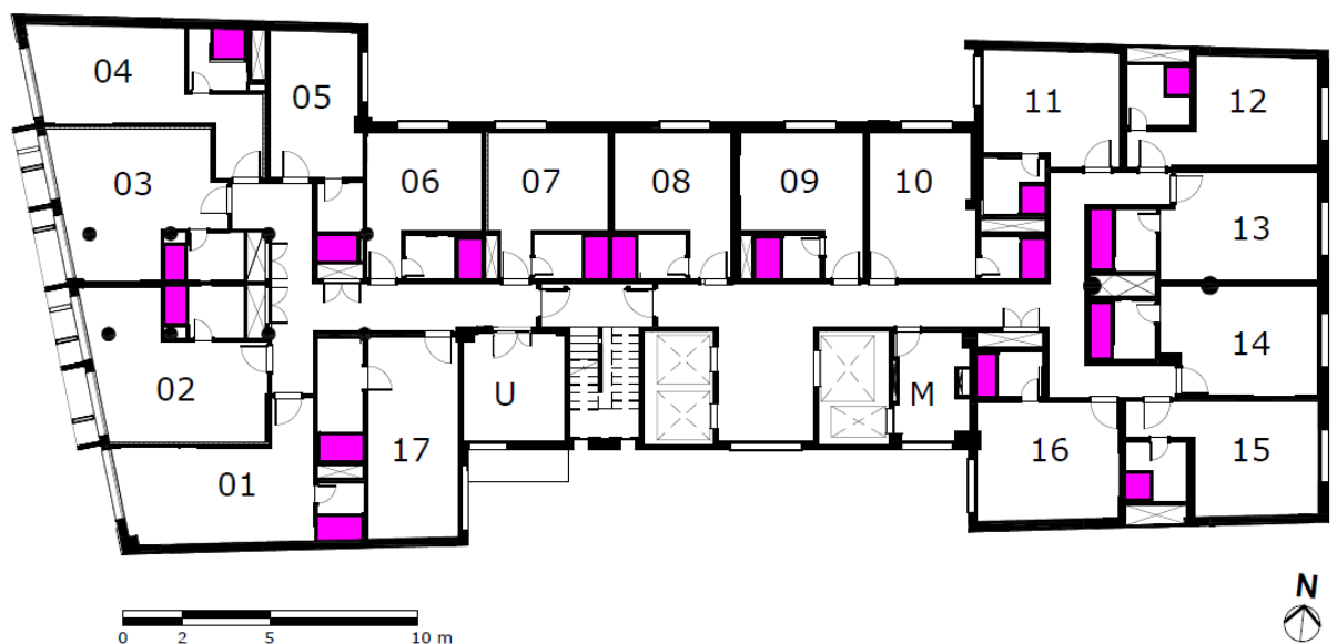
Figura 7 - Mapeamento das áreas impermeabilizadas no pavimento tipo da edificação
