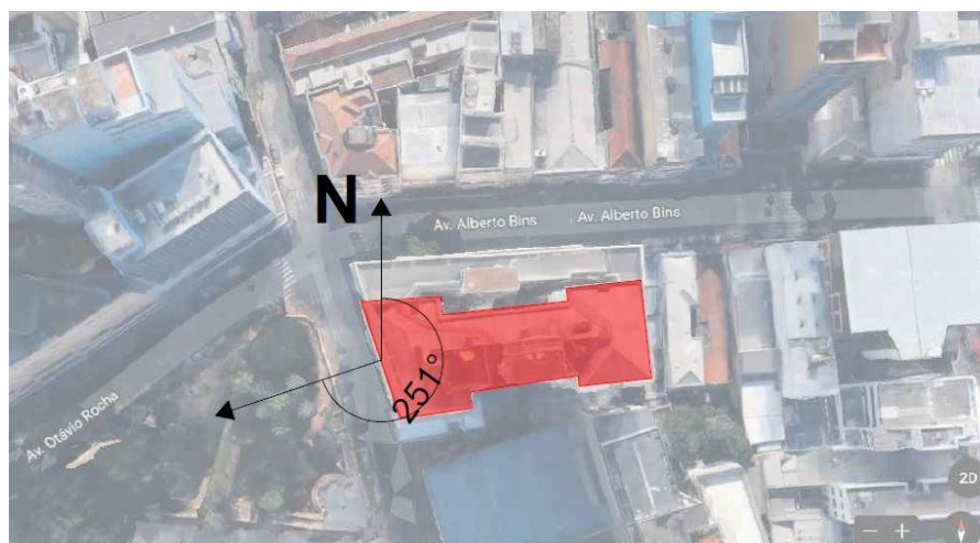
Figura 34 - Obtenção do azimute referente à fachada oeste, no valor de 251^{\circ} .
