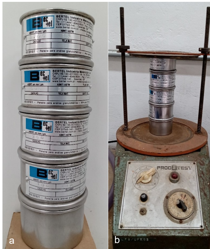
Figura 5. Conjunto de peneiras (a) e agitador mecânico (b) utilizados no estudo sedimentológico da areia.
