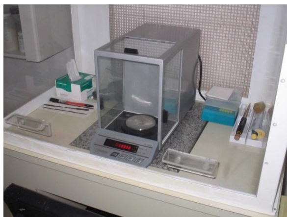
Figura 2. Balança analítica de alta precisão utilizada para pesagem das amostras de rocha total.
