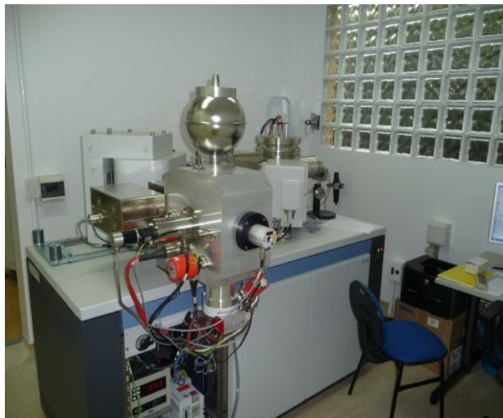
Figura 7. Espectrômetro de massa multi-coletor por ionização térmica TIMS (TRITON) da Thermo Scientific .
