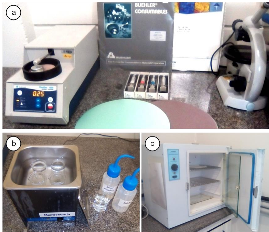
Figura 8: Etapas e equipamentos utilizados na preparação das amostras: (a) politriz semiautomática rotativa, pastas de diamante de diferentes granulometrias, panos para polimento fino e microscópio de luz refletida para acompanhamento do processo; (b) banho de ultrassom e reagentes utilizados na limpeza; e (c) estufa de esterilização e secagem.
