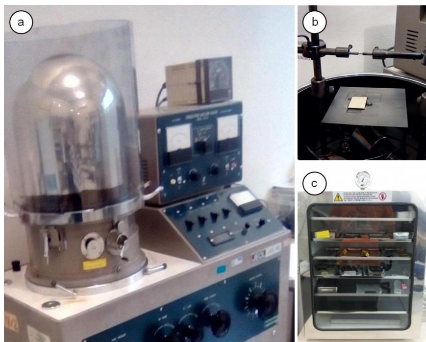
Figura 9: Equipamento utilizado para a metalização das amostras: (a) metalizadora Jeol modelo JEE 4B, (b) detalhe dos eletrodos de carbono e placa de latão posicionados na metalizadora, e (c) dessecador a vácuo tipo dry box para armazenagem das amostras.
