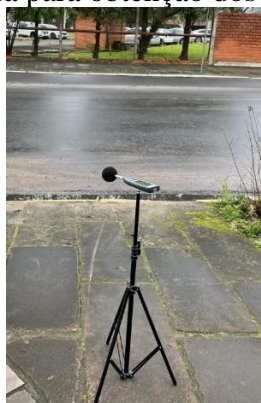
Figura 5.6 – Posicionamento do decibelímetro para leitura do nível de pressão sonora no Ponto 4.
