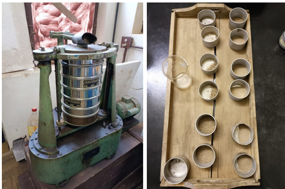
Figura 25: Peneiramento das amostras.
