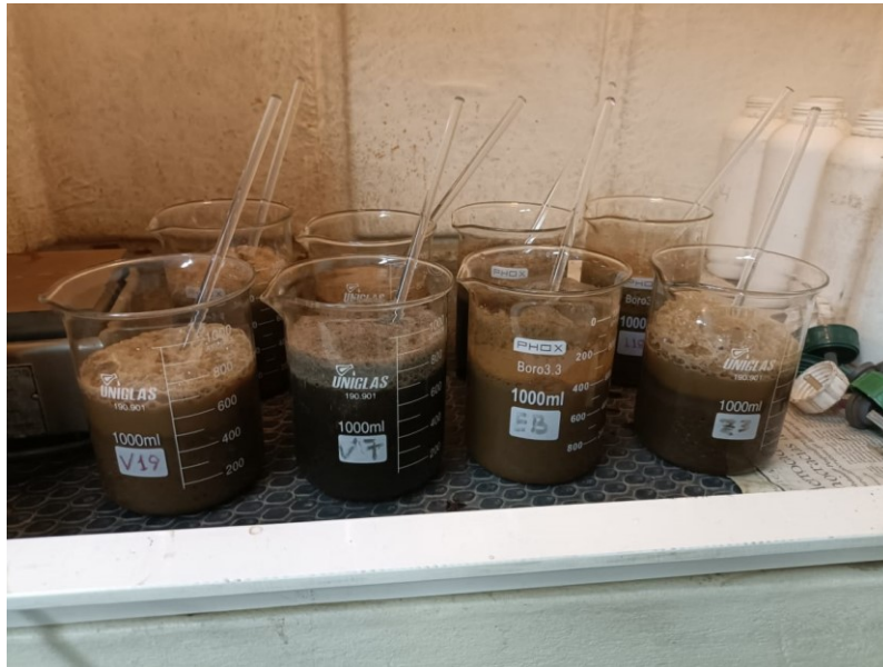
Figura 20: Queima da matéria orgânica das amostras.
