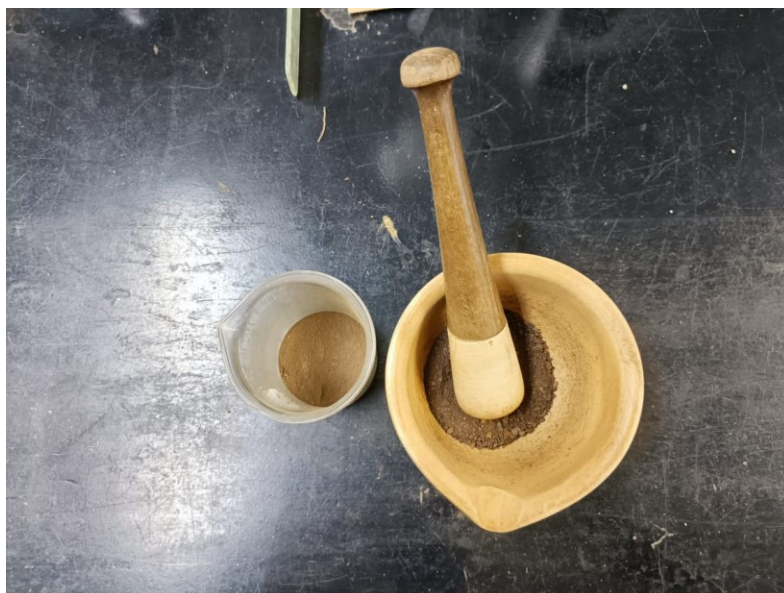
Figura 23: Processo de maceração das amostras.
