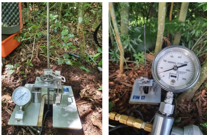
Figura 16: Aplicação do BST em campo.
