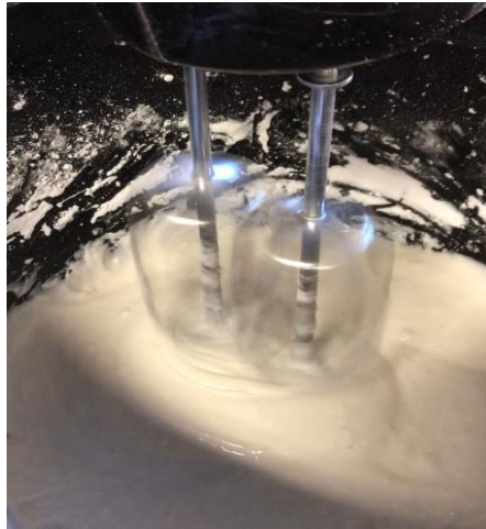
Figura 12 – Processo de mistura com bateadeira para produção das pastas de amido
