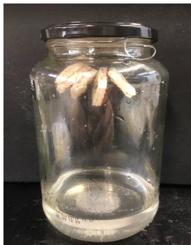
Figura 15 - Sistema utilizado para ensaio de absorção de umidade
