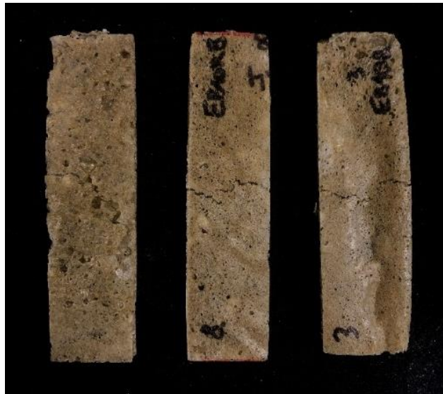
Figura 36 - Amostras de amido batata com 10% de erva mate após ensaio de flexão
