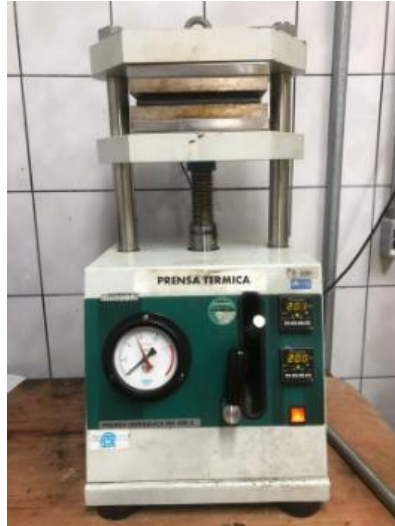
Figura 14 - Prensa hidráulica com aquecimento nas placas
