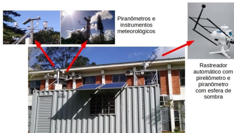
Figura 2 – Estação solarimétrica da UERGS. São vistos os principais instrumentos de medidas das componentes da radiação solar e instrumentos meteorológicos.
