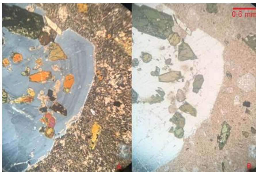
Figura 12: Fotomicrografia representativa de megacristal de sanidina com zonação concêntrica com feições de corrosão e inclusões de piroxênio, feldspatoide e titanita (A- PC; B- PP).
