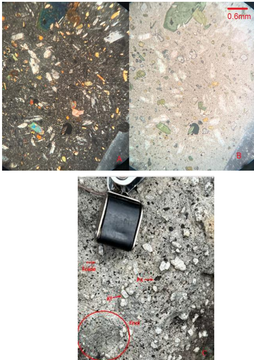
Figura 11: a e b- Fotomicrografia representativa da rocha porfirítica mostrando fenocristais de sanidina, clinopiroxênio, granada e feldspatoides (condições de aquisição da imagem A= nicóis paralelos (PP) e B= nicóis perpendiculares (PC)) C - Rocha porfirítica com fenocristais de piroxênio (Px), k-feldspato (Kf), feldspatoide (Foide) e enclave de granulação fina (círculo vermelho).
