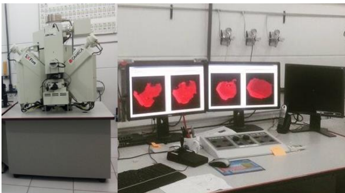
Figura 6: Fotografia da microsonda eletrônica SXfive do CPGq – Igeo – UFRGS.
