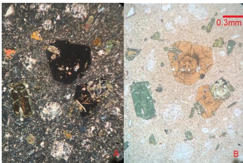
Figura 13: Fenocristais de clinopiroxênio com inclusão de apatita, feldspatoide intensamente carbonatado e granada melanita com inclusões de titanita, apatita e clinopiroxênio (A- PC; B- PP).
