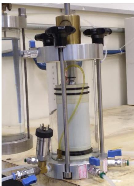
Figura 36 – Ensaio de lixiviação em equipamento de coluna.
