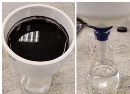
Figura 21 – Exemplo da filtração a vácuo para extrato lixiviado de CBCA.
