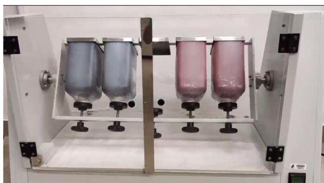
Figura 20 - Agitador rotatório de frasco do ensaio de lixiviação da NBR 10005.
