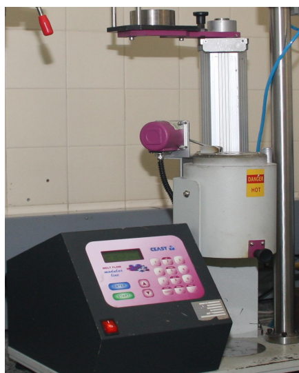
Figura 8: Plastômetro para determinação do IF.
