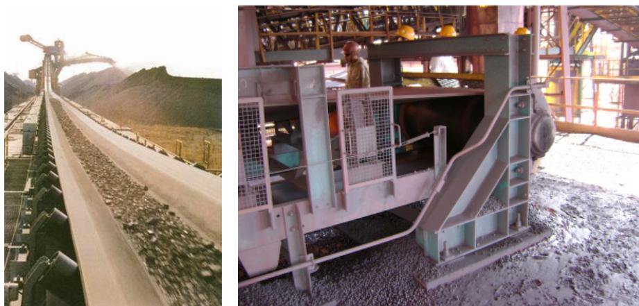
Figura 26: À esquerda, correia transportadora de minério. Estação de retorno. (fonte: Web/TMSA)
