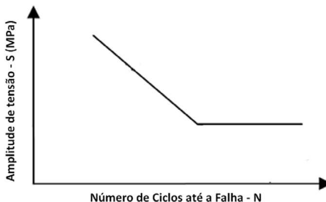
Figura 5 - Exemplo de uma curva S-N
