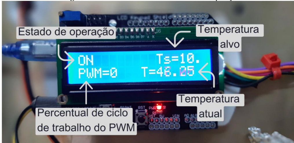
Imagem 7 – Tela de monitoramento de estado de operação.
