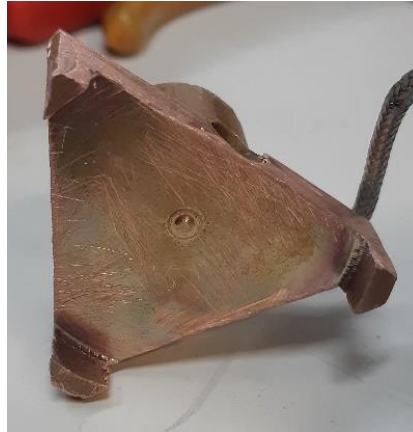
Figura 3 - Vista inferior do núcleo de Cobre, destaque para os três pontos de apoio
