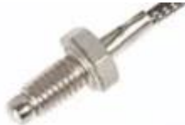
Figura 6 - Imagem do termopar do tipo K utilizado nesse trabalho
