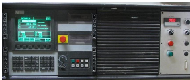
Figura 7: Exemplo de comando CNC datado dos anos 90.
