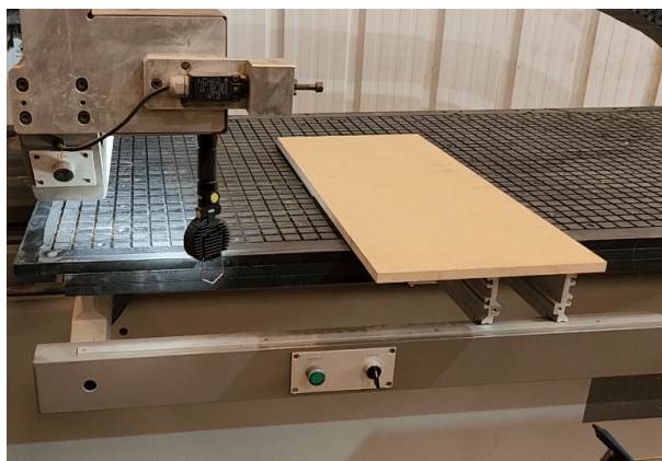
Figura 28: Preparação do material bruto a ser usinado sobre uma das mesas.
