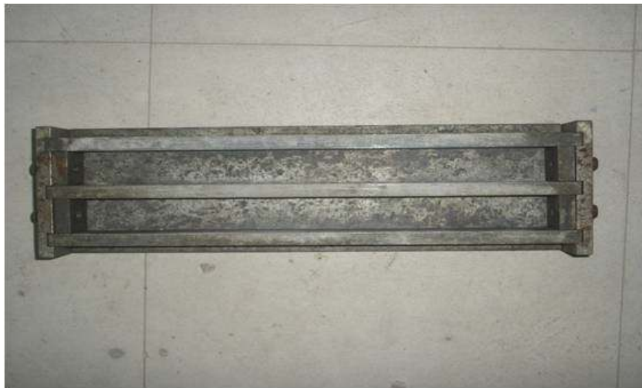
Figura 15: fôrma de aço para moldagem das barras de argamassa
