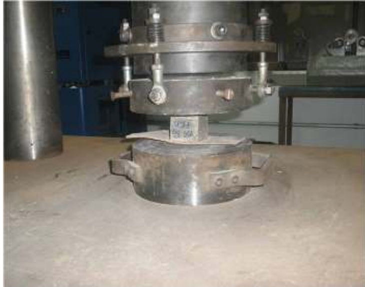
Figura 14: ruptura à compressão dos cubos
