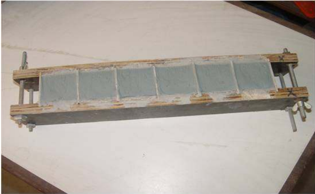
Figura 12: moldagem dos cubos de argamassa para cada traço
