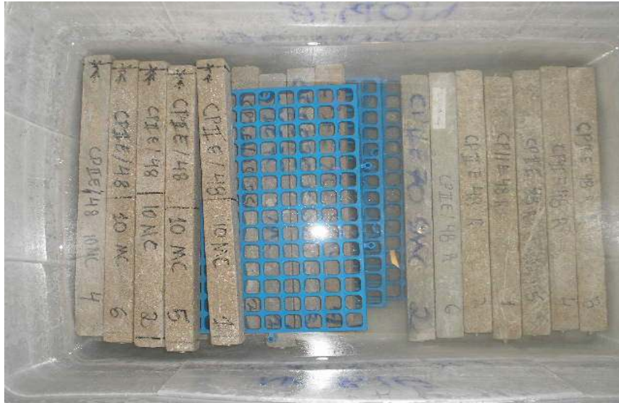
Figura 17: barras de argamassa em solução de sulfato de sódio
