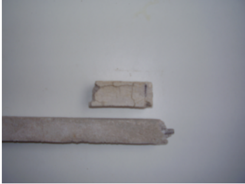
Figura 36: perda de massa e fissuração nas barras de argamassa pelo ataque por sulfatos
