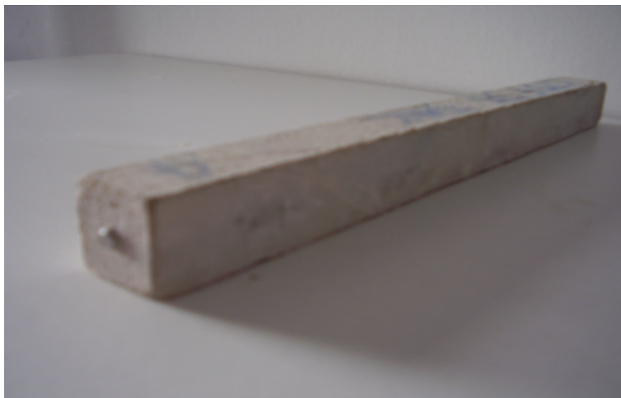
Figura 16: barra de argamassa para ensaio em solução de sulfatos
