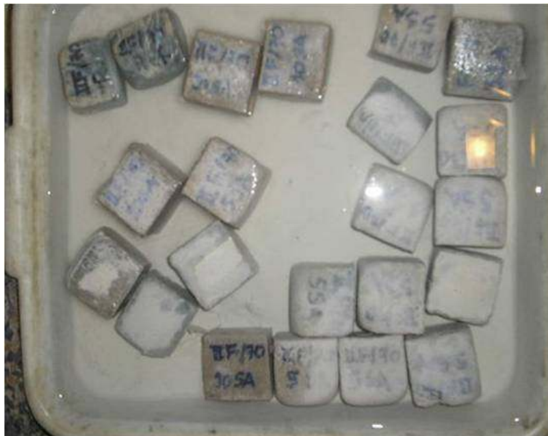
Figura 13: cura dos cubos em água com cal a 23 \pm 1,7^\circ\text{C}
