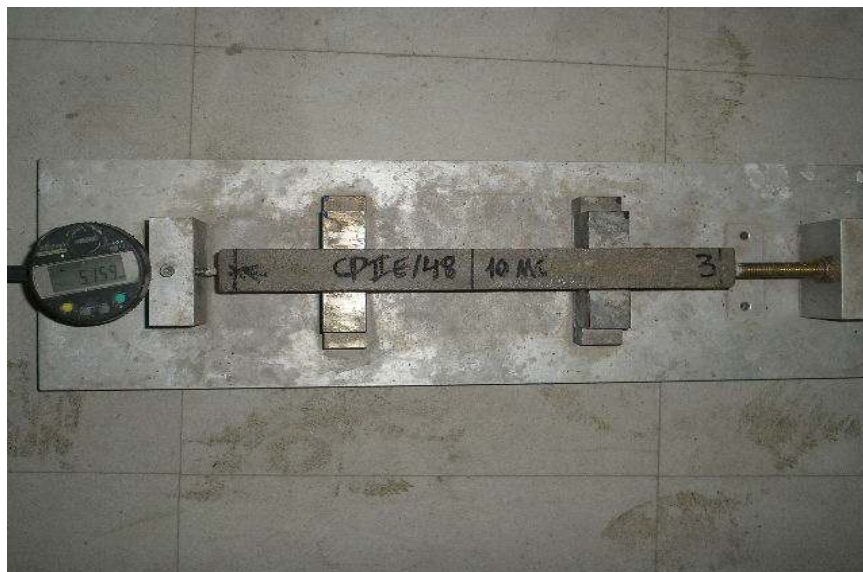
Figura 19: leitura das barras com relógio digital em base comparadora
