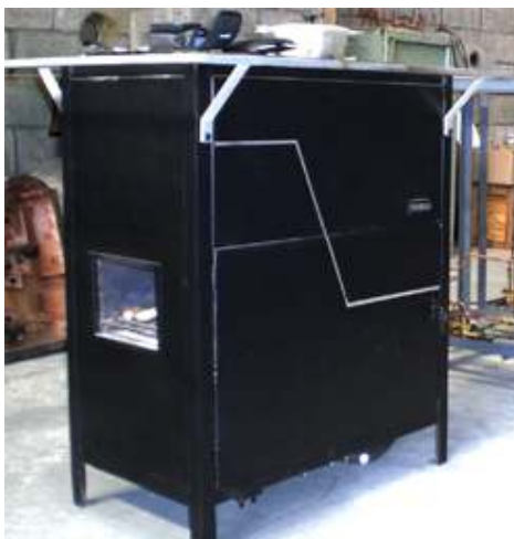
Figura 10: fogão com capacidade de gerar e armazenar energia elétrica (HINRICHS; KLEINBACH, 2008)
