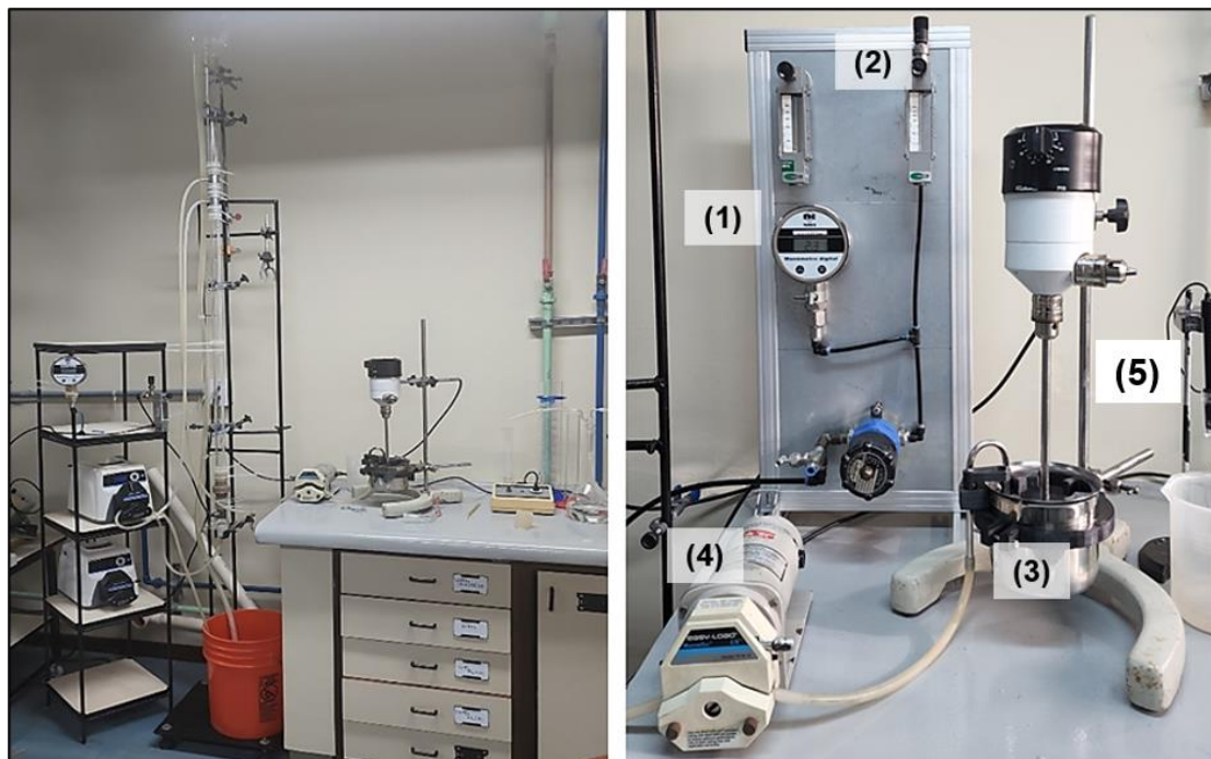
Figura 16. Montagem experimental do sistema de flotação. Na foto esquerda o sistema de flotação em coluna, e na foto direita painel com manômetro (1) e fluxômetro de ar (2), tanque de condicionamento com motor de agitação (3), bomba de alimentação (4) e medidor de pH (5).
