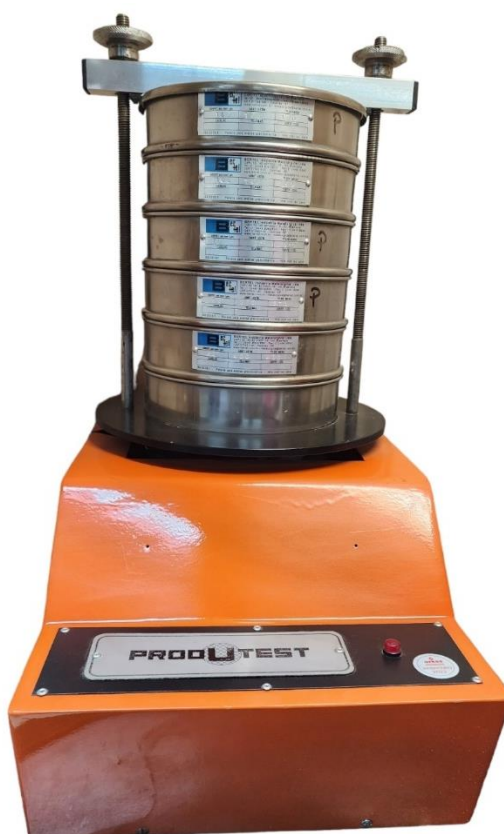
Figura 13. Agitador mecânico utilizado para realização das análises granulométricas por peneiramento.
