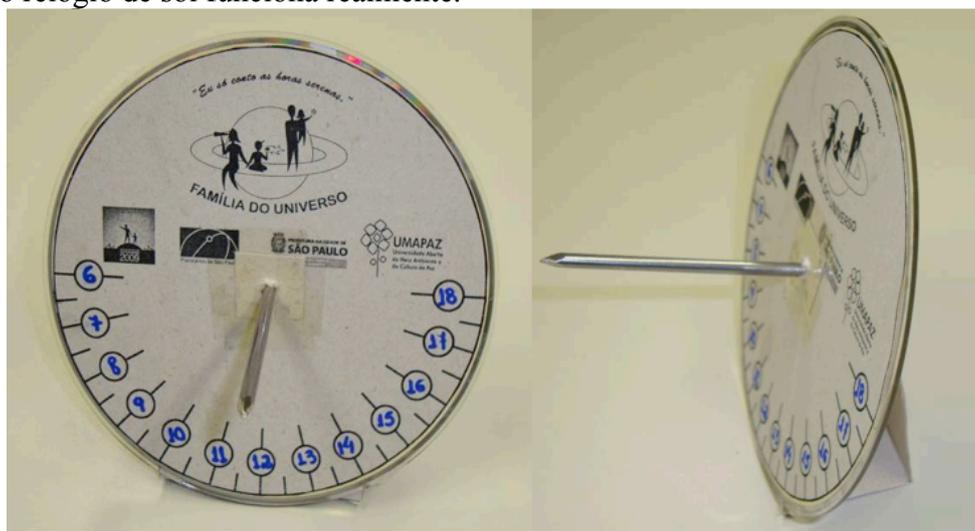
Figura 3: Imagem do relógio equatorial montado.
