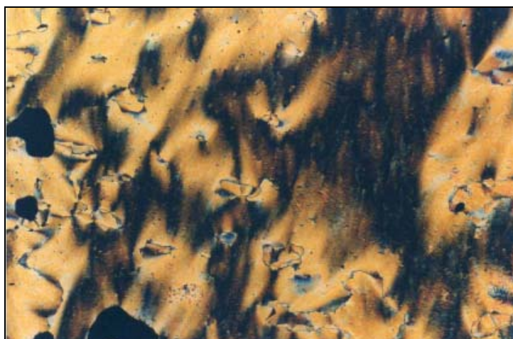
Textura mosaico da mesofase esmética I no selenoéster 1b , resfriamento (10x), 100,5°C.
