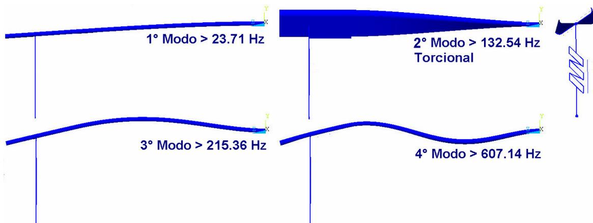
Figura 5.13: Modos e frequências naturais para o modelo com Amortecimento Histerético.
