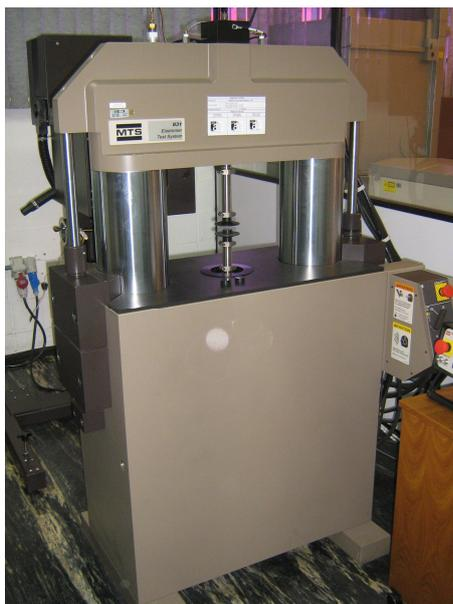
Figura 5.43: Máquina de ensaios dinâmicos - CETEPO.
