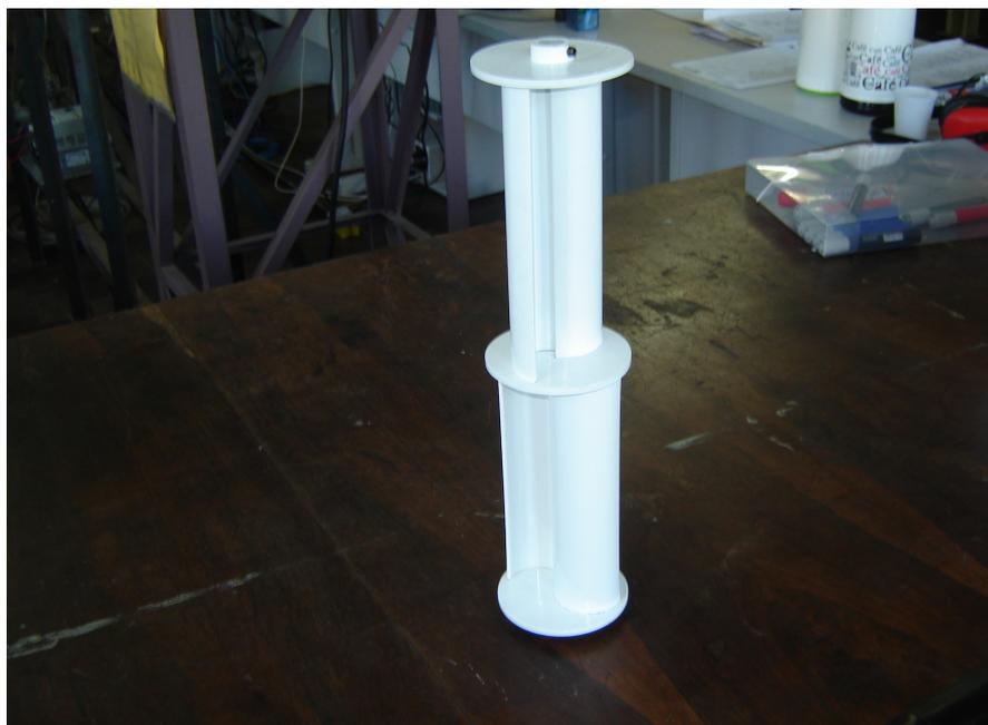
Figura E.1 – Modelo reduzido de rotor Savonius confeccionado para futuros testes de desempenho
