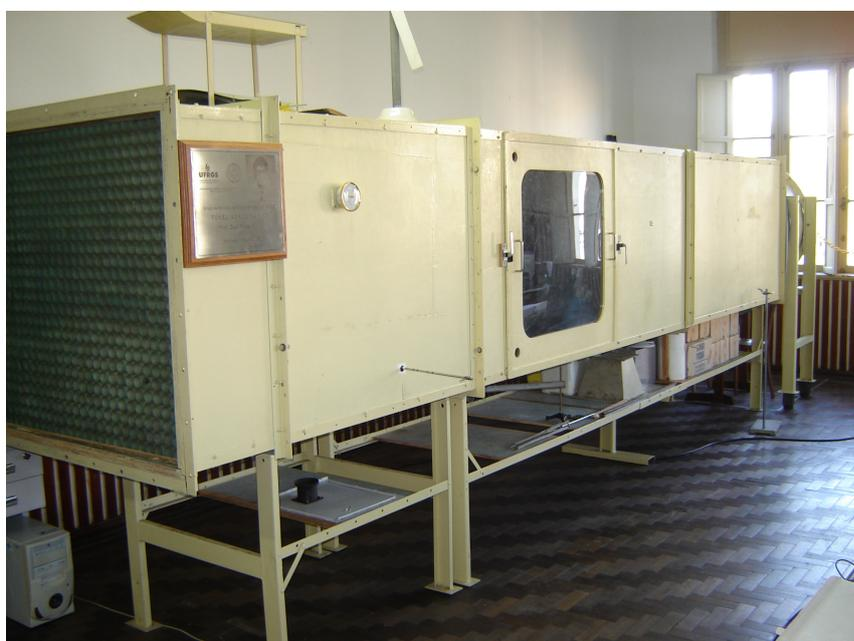
Figura E.3 – Canal aerodinâmico cujo uso é pretendido nos futuros testes de desempenho
