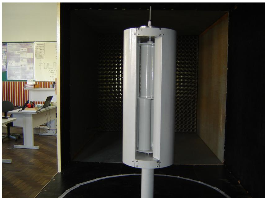
Figura E.2 – Modelo reduzido de turbina Savonius com estator cilíndrico de 2 aberturas confeccionado para futuros testes de desempenho
