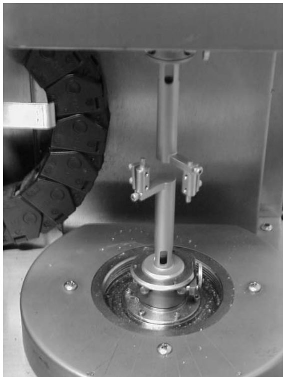
Figura 3.1: Geometria Film Tension acoplada ao reômetro
