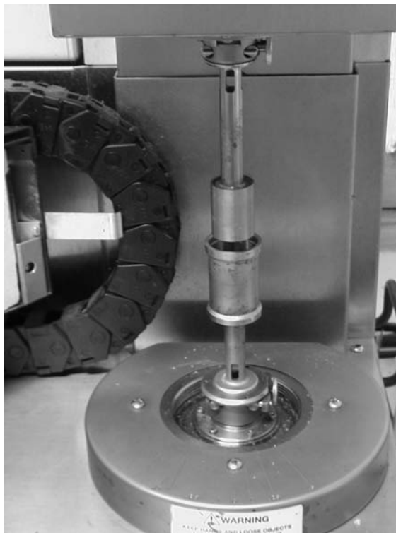
Figura 3.2: Geometria Couette acoplada ao reômetro
