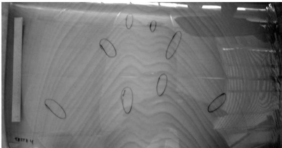
Figura 4.53: Chapa manufaturada durante os testes COEX 05, na esteira da co-extrusora. Pode-se ver as marcas deixadas pelas instabilidades do tipo onda
