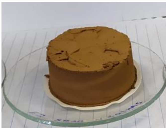
Figura 47- Torta obtida através de filtração do rejeito UF 2 em filtro de pressão positiva em escala de bancada. Condições: P = 8 bar (800 KPa); tempo de secagem (sopro) da torta = 3 min; 55% de sólidos; meio filtrante de papel; sem NBs; pH 7,5.
