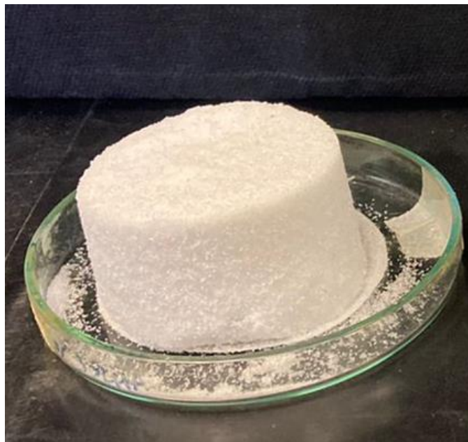
Figura 50- Torta obtida após filtração de polpa contendo partículas de quartzo com granulometria grossa. Condições: P = 8 \text{ bar (800 KPa)} ; tempo de secagem (sopro) da torta = 3 min; 50% de sólidos; meio filtrante de papel; com NBs; 180 g/t de amina; pH 7,5.
