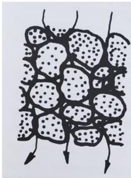
Figura 11- Leito de partículas que constitui a torta de filtração.
