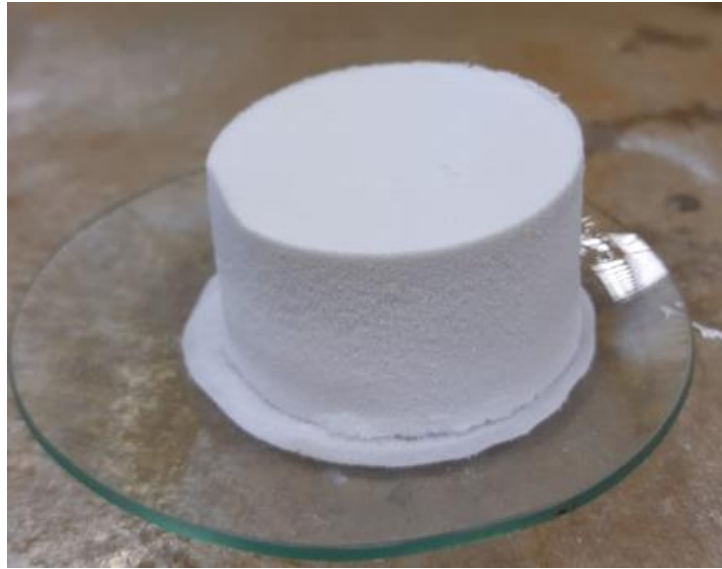
Figura 49- Torta obtida após filtração de polpa contendo partículas de quartzo com granulometria média. Condições: P = 8 \text{ bar (800 KPa)} ; tempo de secagem (sopro) da torta = 3 min; 50% de sólidos; meio filtrante de papel; com NBs; 180 g/t de amina; pH 7,5.
