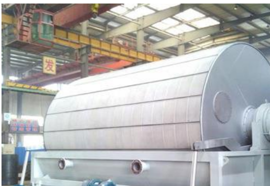
Figura 7- Filtro de tambor. a) À esquerda uma visão lateral apresentando o tambor coberto com meio filtrante. b) À direita o ciclo de filtragem para o filtro de tambor.
