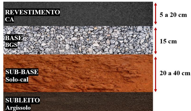
Figura 17: Estrutura 1 - pavimento semirrígido invertido (sub-base em solo-cal)
