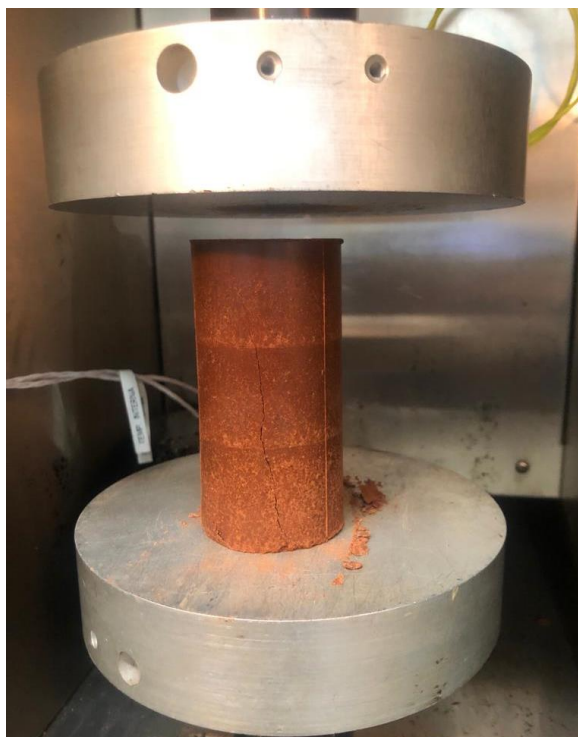
Figura 10: Corpo de prova de solo-cal após do ensaio de RCS
