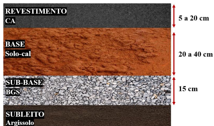
Figura 19: Estrutura 3 – pavimento semirrígido (base em solo-cal)
