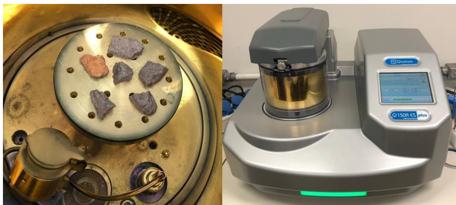
Figura 14: Metalização das amostras para análise MEV
