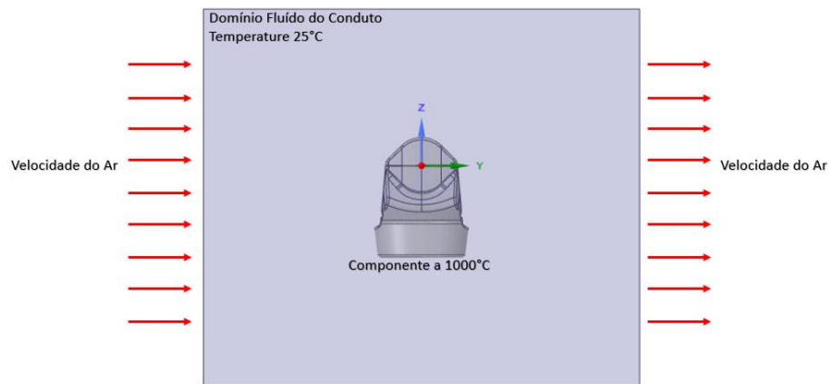
Figura 13 - Condições de contorno de convecção forçada
