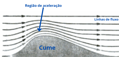
Figura 2.2 – Linhas de fluxo de vento sobre um cume. Fonte: Adaptado de (ELDRIDGE, 1980).
