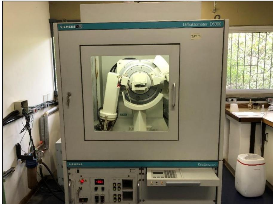
**Figura 8: Difratômetro de Raios-X D-5000, da marca Siemens (Laboratório de Análises Química e Mineralógica de Materiais Sólidos do Instituto de Geociências/UFRGS)**
