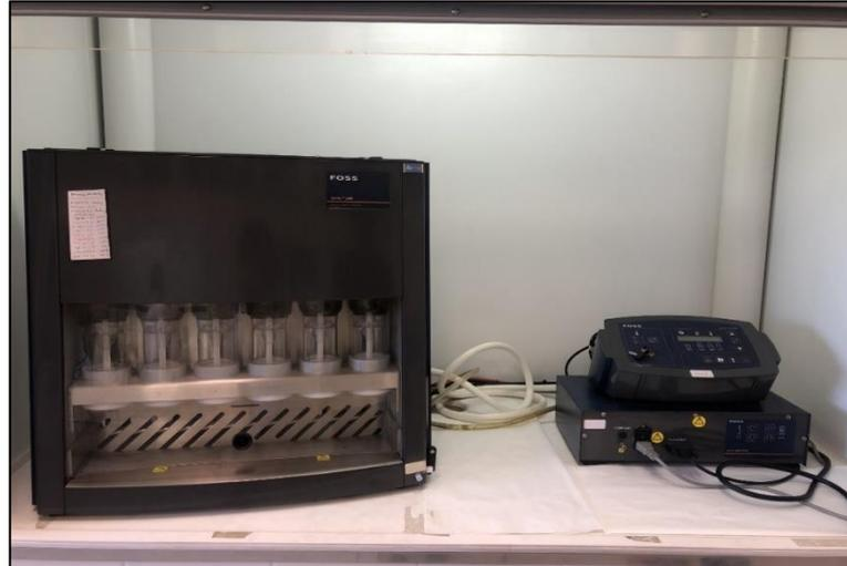
**Figura 6: Equipamento Soxtech™ da marca *FOSS Analytics* utilizado para extração do extrato orgânico. Equipamento disponível no Laboratório de Carvão e Rochas Geradoras de Petróleo/UFRGS.**
