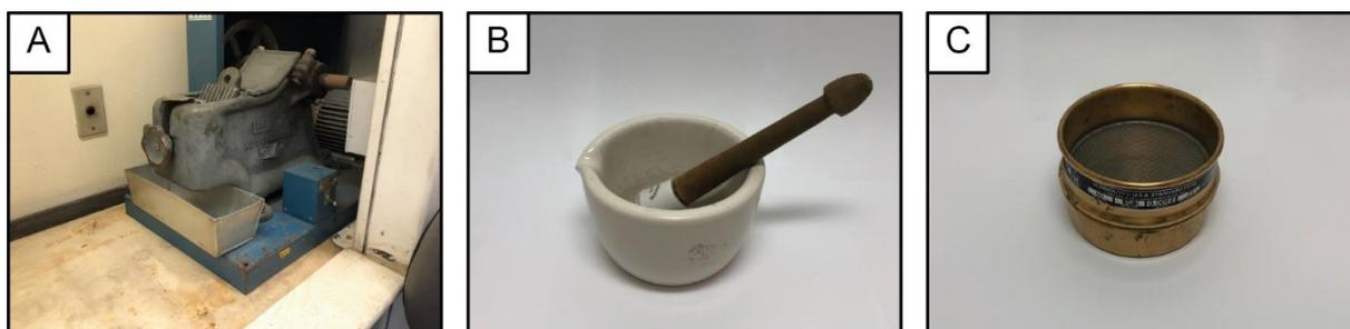
**Figura 5: Material utilizado para trituração e cominuição das amostras estudadas. (A) Triturador de mandíbulas; (B) Gral de porcelana com pistilo; (C) Peneira de 60 *mesh*. Itens disponíveis no Laboratório de Carvão e Rochas Geradoras de Petróleo/UFRGS.**
