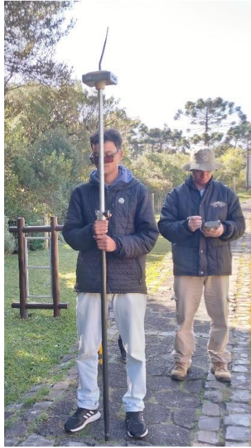
Figura 4.8: Receptor GNSS utilizado como rover , para coleta dos dados da trilha.
