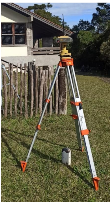
Figura 4.7: Receptor GNSS posicionado em um ponto de coordenadas conhecidas.
