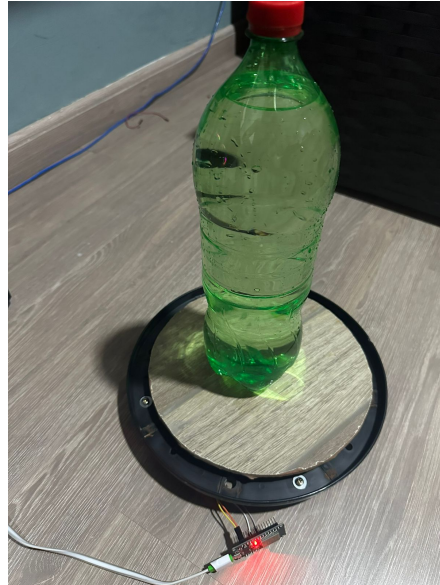
Figura 28: Teste com uma Garrafa com 2,0 kg
