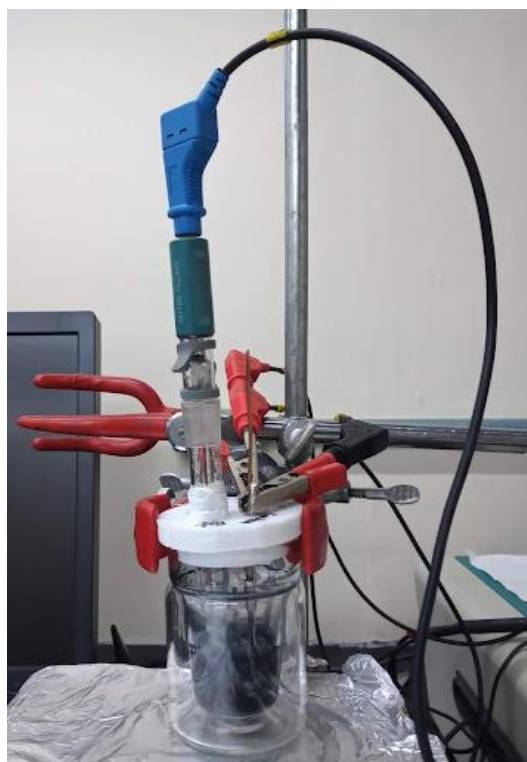
Figura 12. Cella eletroquímica de três eletrodos, onde foram realizadas as sínteses dos filmes.
