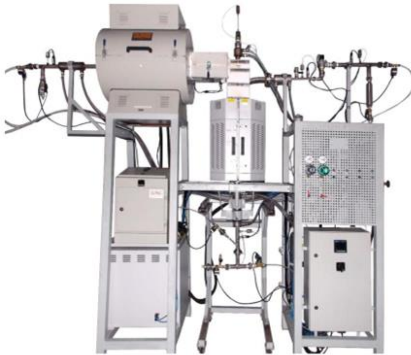
Figura 4 - Simulador de PCI do LaSid – (Barbieri 2018)
