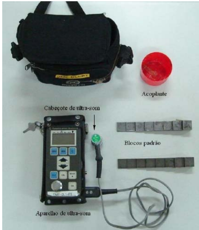
Figura 12 - Equipamento para medição de espessura por Ultra som.
