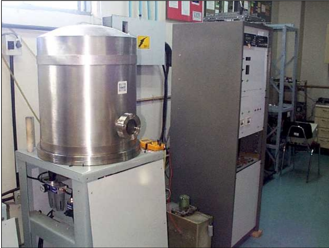
Figura 3.2 - Nitretador a plasma (200 litros) utilizado para nitretar as ferramentas.
