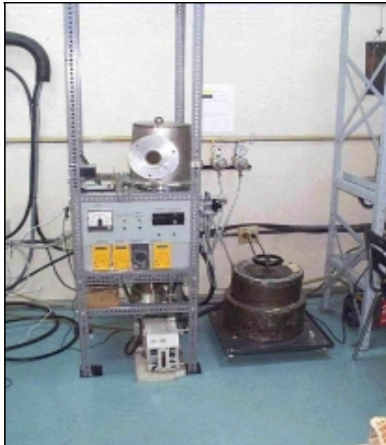
Figura 3.1 - Nitretador a plasma (17 litros) utilizado para o tratamento das amostras.
