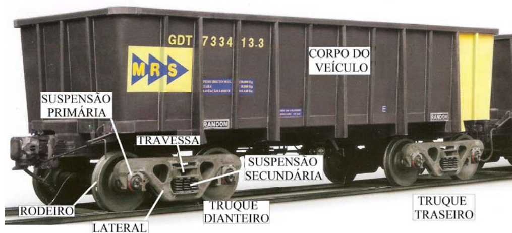
Figura 3.3 – Componentes de um veículo ferroviário [RANDON, 2010]
