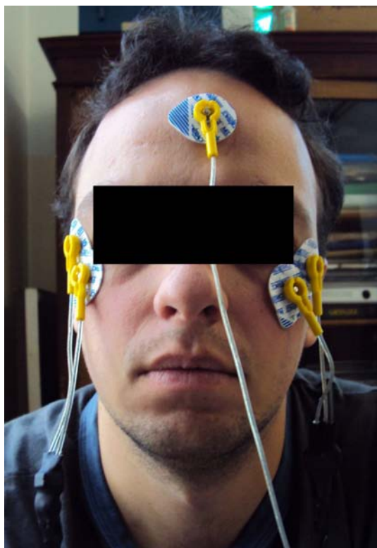
Figura 4.24 - Posicionamento dos eletrodos para as medições.
