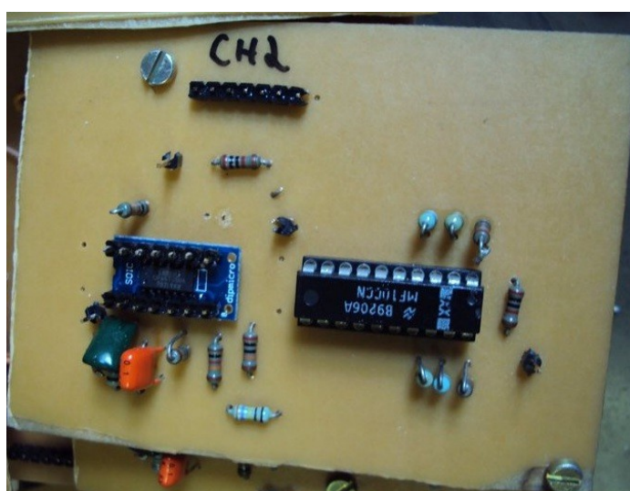
Figura 4.9 - Foto da placa de circuito impresso criada para o estágio de filtragem.
