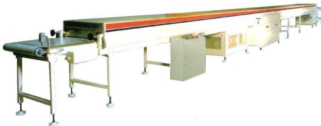
Figura 6: Túnel de resfriamento
