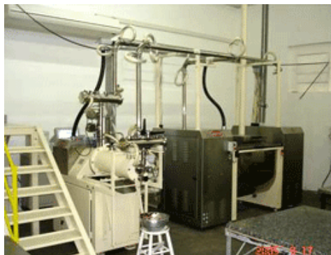
Figura 3: Equipamento que realiza mistura, conchagem e refino.
