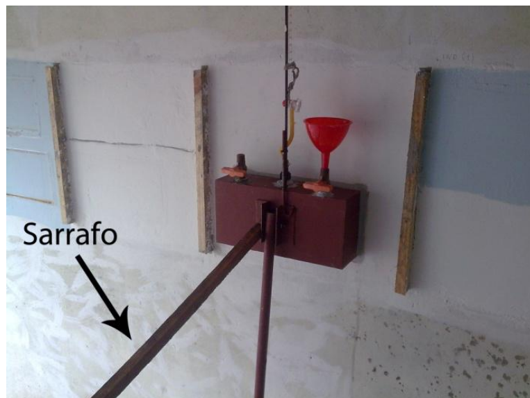
Figura 34: sarrafo utilizado para pressionar o aparato contra a parede a ser ensaiada
