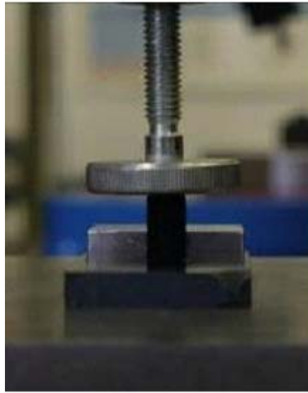
Figura 5.10: Foto de um corpo-de-prova no equipamento, durante o teste de compressão.
