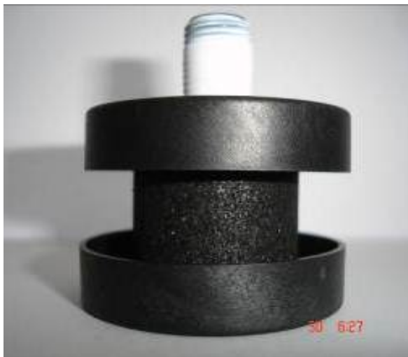
Figura 5.8: Amostra pronta para os testes de remoção de cloro.
