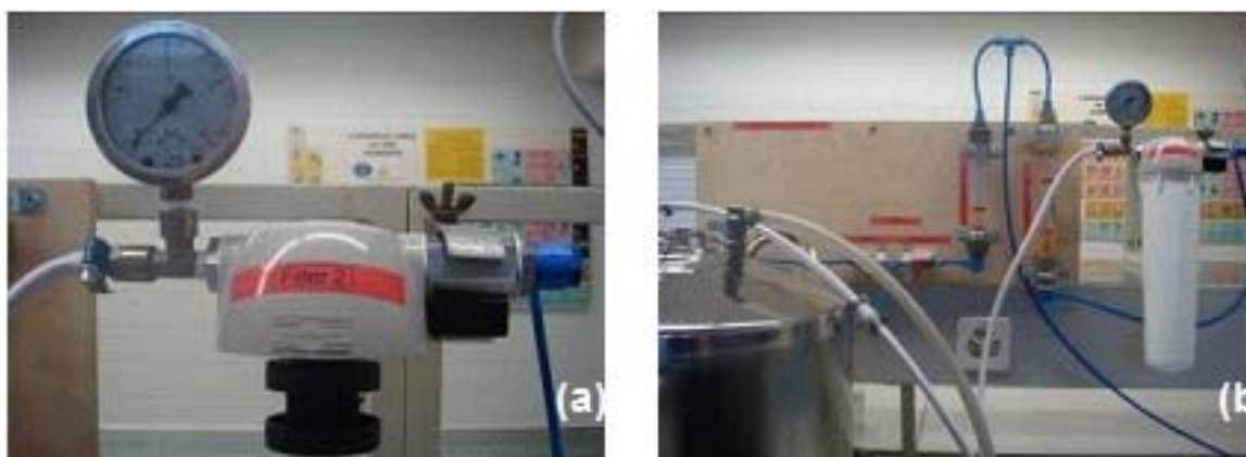
Figura 5.9: Sistema de filtragem: filtro conectado ao suporte (a); vista do sistema (b).
