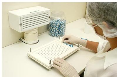
**Figura 10 – Exemplo de encapsuladora manuais**
