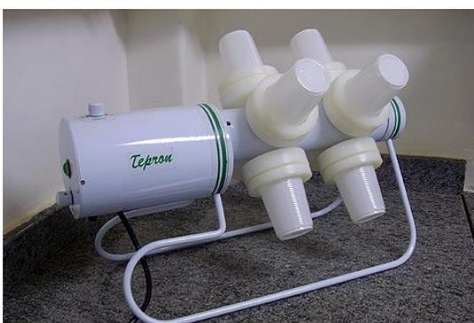
**Figura 12 – Exemplo de misturador automático de medicamentos**
