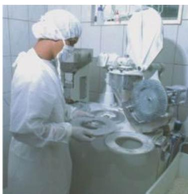
**Figura 11 – Exemplo de encapsuladora semiautomática de última geração**
