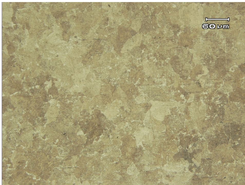
Figura 3.2 Metalografia da amostra analisada, microestrutura perlítica-ferrítica.
