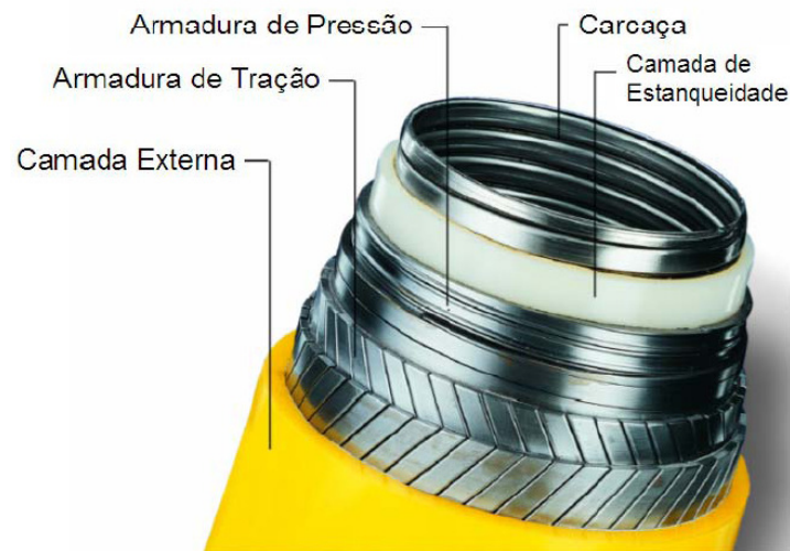
Figura 2.2 Configuração típica de um duto flexível.[5]
