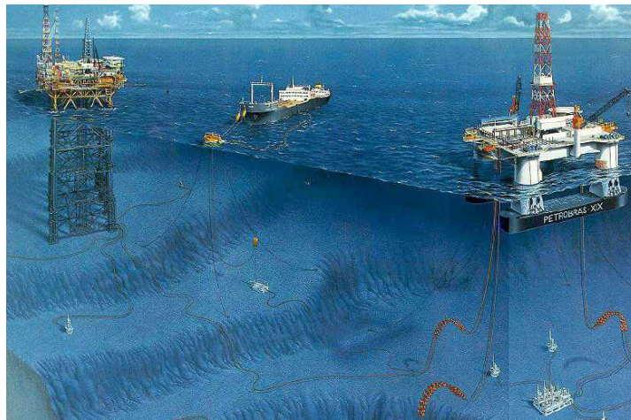
Figura 2.1 Sistemas produção de petróleo “Off Shore” (da esquerda para a direita tem-se: Plataforma fixa, Navio de produção FPSO e Plataforma semi-submersível [2].
