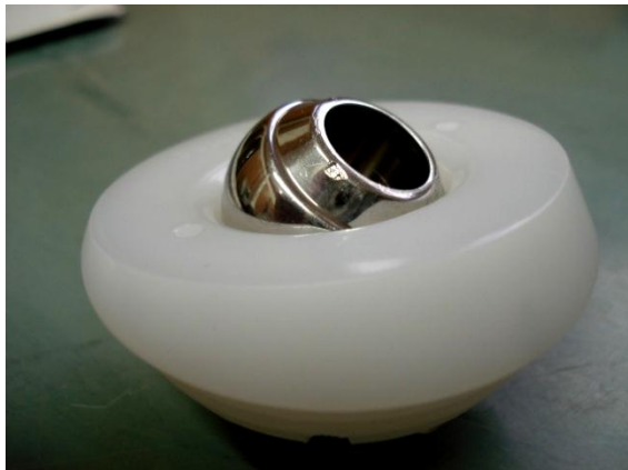
Figura 23 - Amostra de ensaio. Cabeça femoral de aço inox ASTM F138 de 28 mm de diâmetro e acetábulo de UHMWPE.
