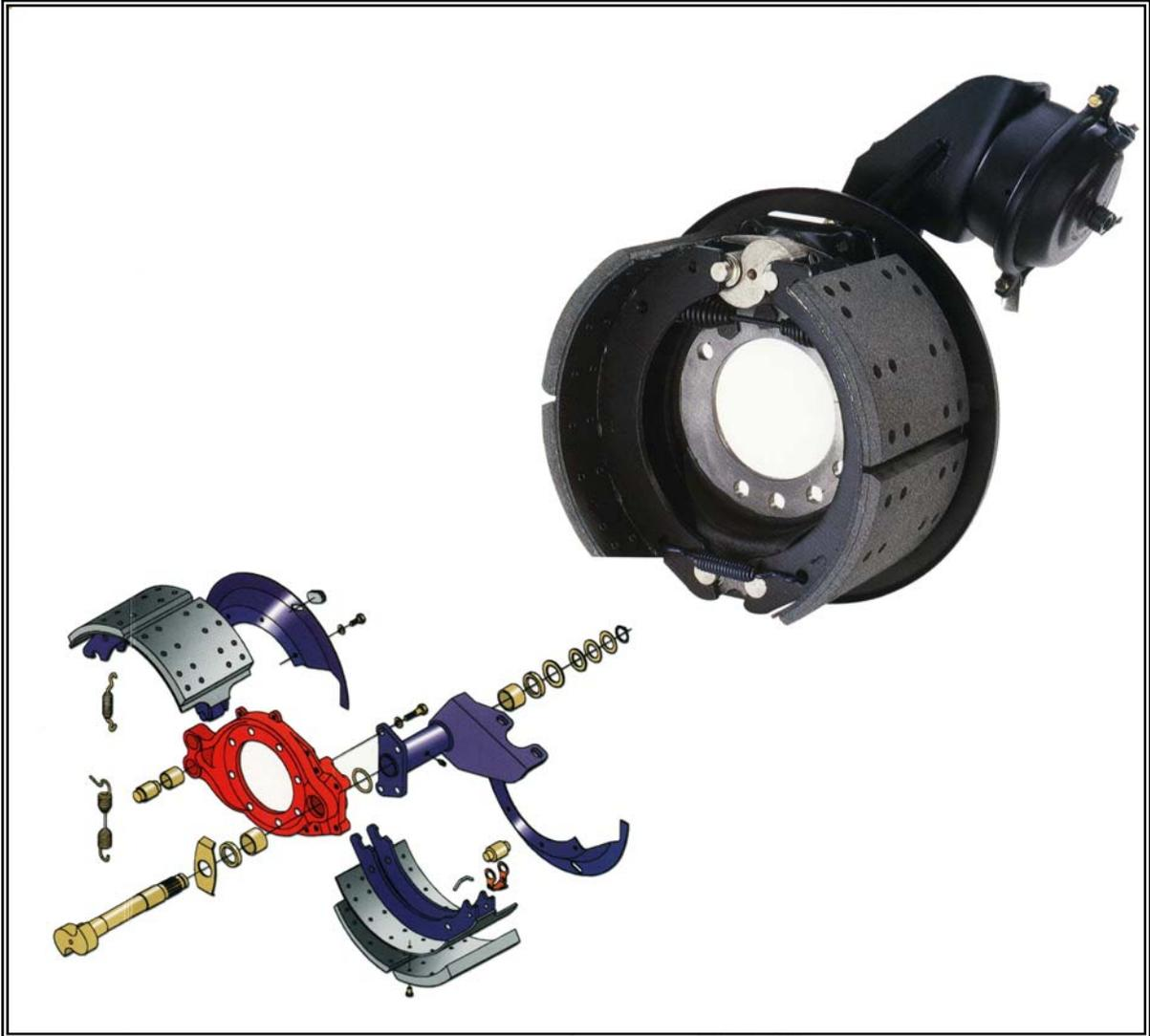
**FIGURA 25** - Freio Master decomposto. O componente “spider” aparece em vermelho
